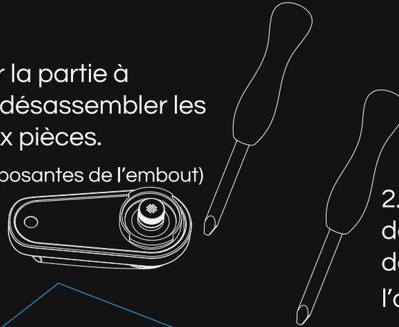
2. Réutiliser l'ouvreur à nouveau afin de dégager la partie à l'écart tel que démontré, afin de désassembler l'anneau de silicone.
